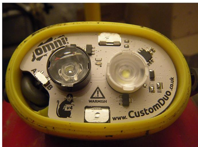
La variation de l'éclairage s'obtient par bascule successive de l'interrupteur (mode 1 : 20 lm > mode 2 : 85 lm > mode 3 : 150 lm > mode 4 : 210 lm). Depuis le mode 1, un mode 5 de sécurité de 4 lumens est accessible par une double bascule rapide de l'interrupteur. Dès l'activation de ce mode, une diode rouge clignote de 1 à 5 fois pour indiquer le niveau de charge. Depuis les modes 2 à 4, le mode 6
