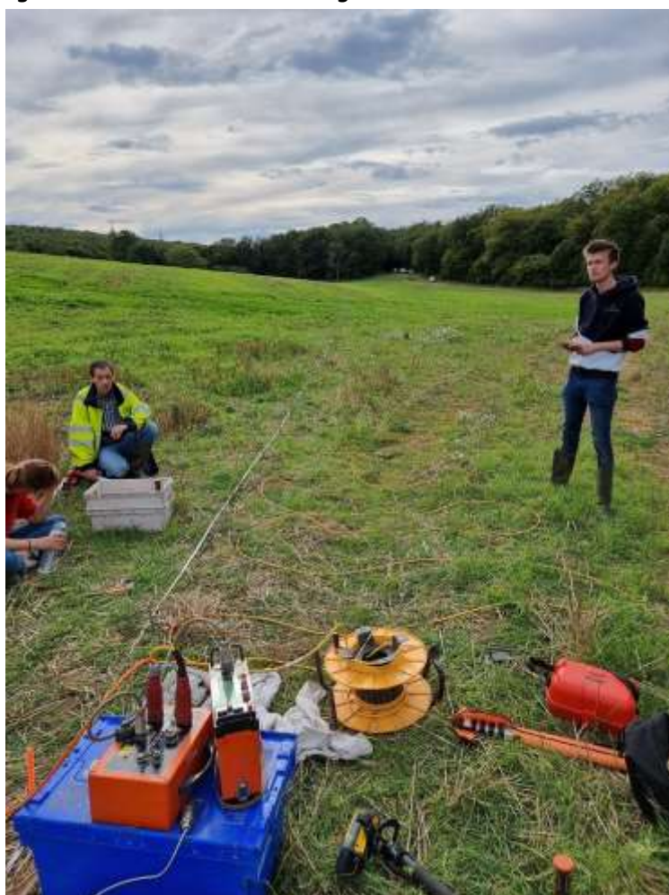
Première campagne de tomographie électrique 2D sur le secteur du Fond de la Souche à Harmonville (88) avec l'université UniLaSalle de Beauvais (cliché : O. Gradot, 1/10/2021)
